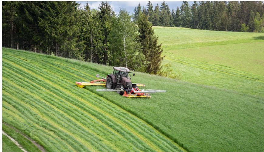
«Sensosafe» von Pöttinger arbeitet mit Infrarot-Beleuchtung: Fell reflektiert anders als Gras, was die Sensoren erkennen und melden. In der Schweiz gibt es heuer Versuche mit Sensosafe. (Bild: Pöttinger)
