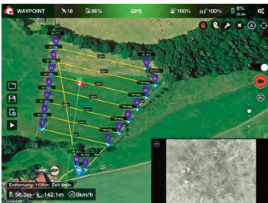
So sieht ein Wegpunkte-Flugplan nach HAFL-Methode aus, der von der Drohne automatisch abgeflogen wird.
