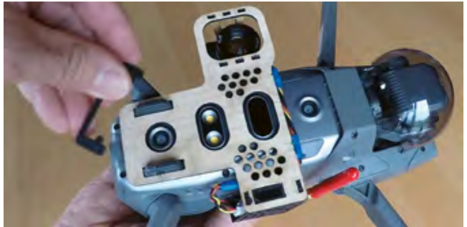
Die benötigten Komponenten werden mit einer ultraleichten Konsole als Einheit an der Drohne befestigt.
