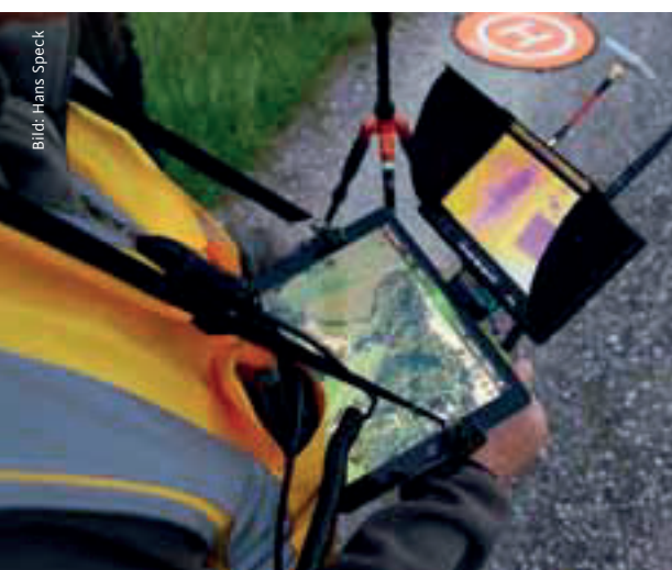
Alles auf einem Blick: Die Funktionen der Drohne auf dem Programmierungs-Tableau und das Bild von der Wärmekamera der Drohne mit dem Standort des gefundenen Objekts.
