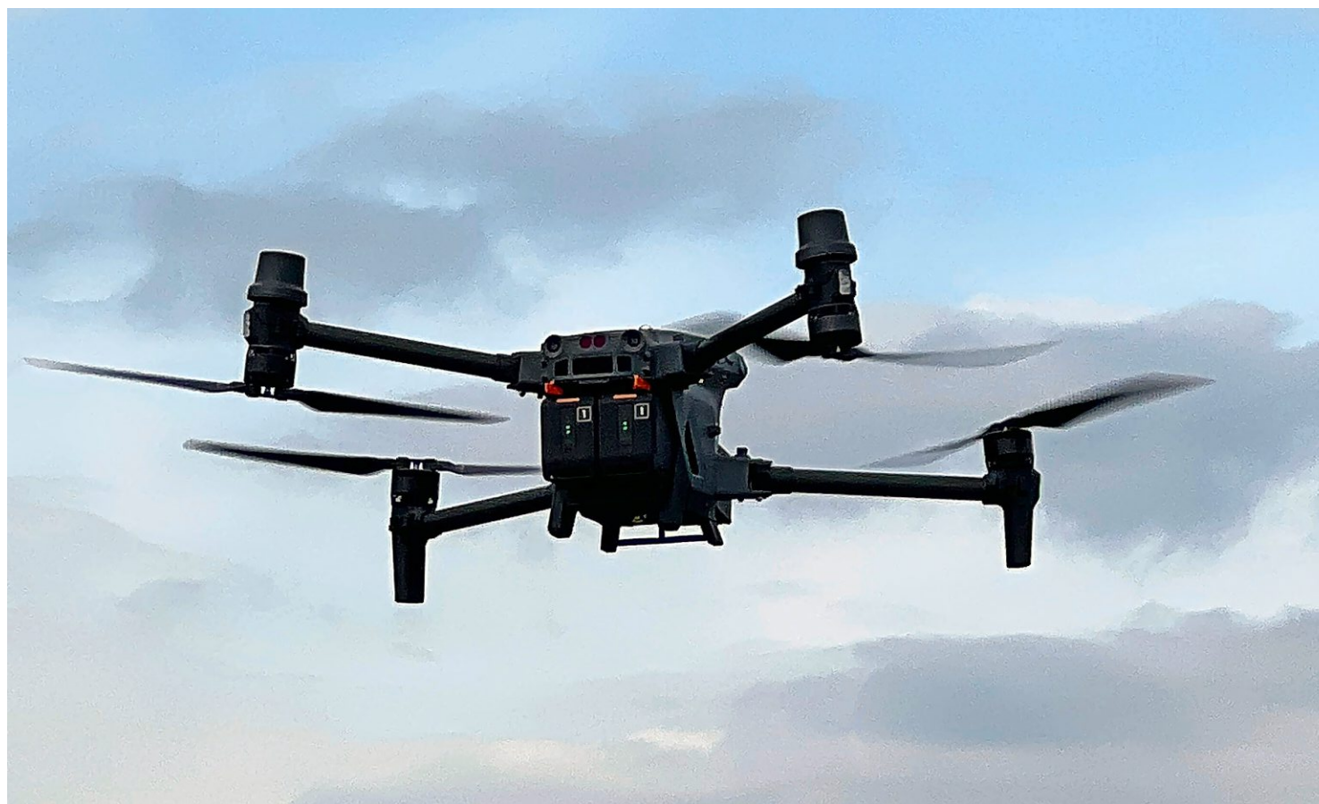
Die Drohne Typ M30T mit integrierter Wärmebildkamera hat einen Wert von 12'000 Franken. Mit ihr können Rehkitze gerettet werden. Foto: Tommy Hafner
