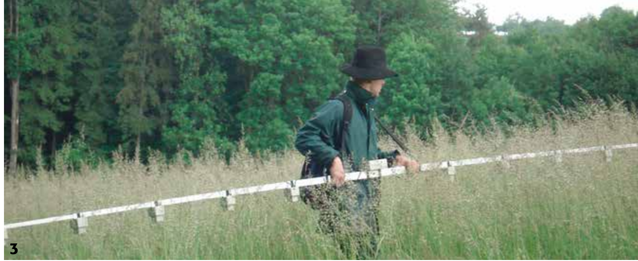
Ein getragener ISA-Wildretter mit Infrarotsensoren hilft, Rehkitze sicher in Wiesen aufzuspüren. Foto: Nicole Berger
