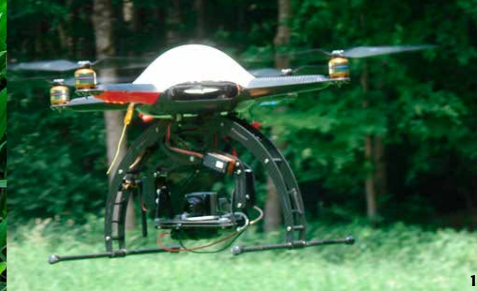
Quadrokopter mit Kameragestell und Thermal-kamera beim Einsatz für die Rehkitzsuche. Foto: Nicole Berger
