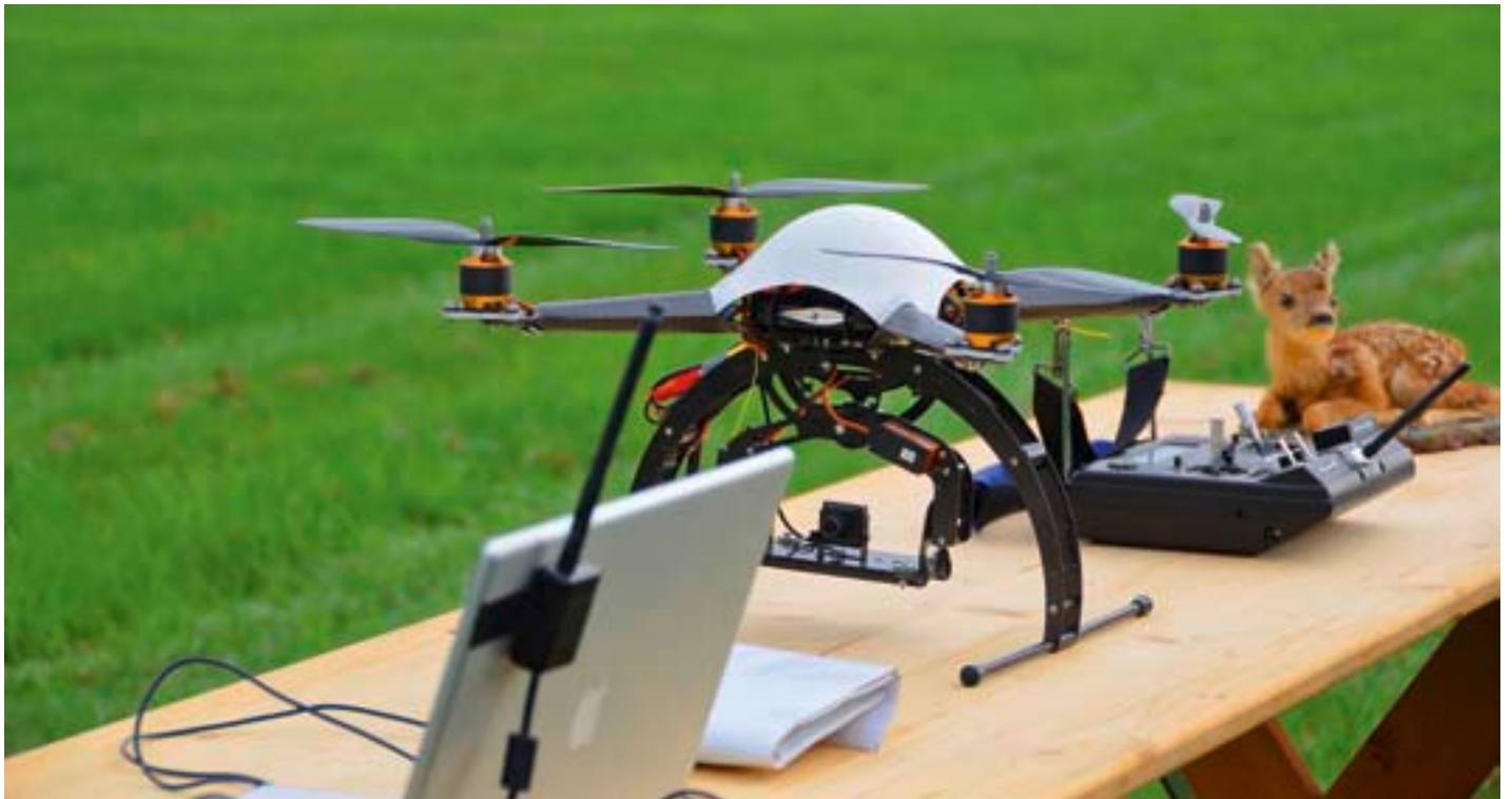
Computer, Multikopter, Wärmebildkamera, Fernbedienung samt kleinem Bildschirm (nicht auf dem Bild) gehören zur Ausrüstung, um Rehkitze in hohen Grasbeständen einfach zu finden. (Quelle: IGP ETHZ, UAVg-2011)
