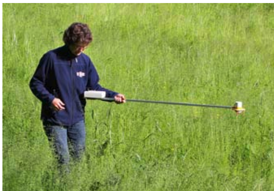
Abbildung 6: Infrarotsensor HAF zum Aufspüren von Rehkitzen im hohen Gras, wenn die Standorte ungefähr bekannt sind. (Quelle Walter Berger)
