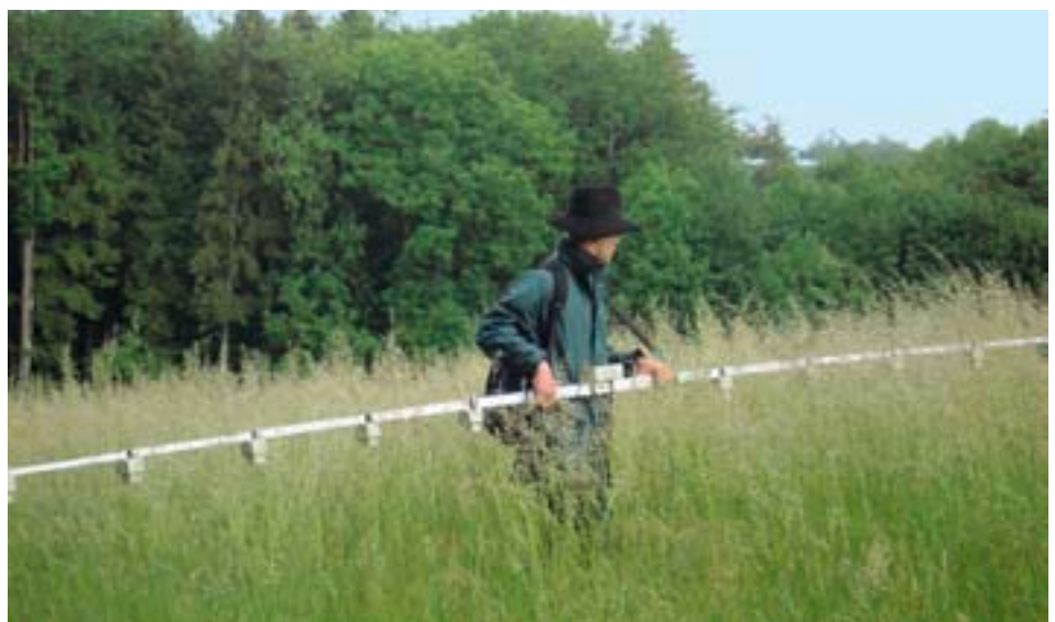
Abbildung 2: Ein getragener ISA-Wildretter mit Infrarotsensoren hilft Rehkitze in Wiesen aufzuspiiren. (Quelle: Nicole Berger)
